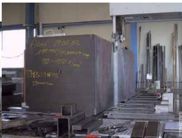
Lechner hält unzählige Sondergüten auf Vorrat, z. B. 1.4057+QT, 1.4305, 1.4112 (links) oder auch Nitrierstahl (oben rechts) 1.8519 (vergütet 950-1050 N/m 2 ), hier auf der Blockbandsägemaschine
